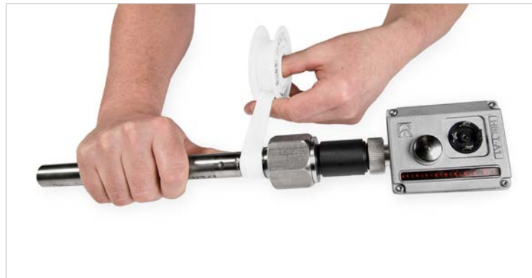
Poser le ruban en Téflon sur le filetage pour le NPT".
