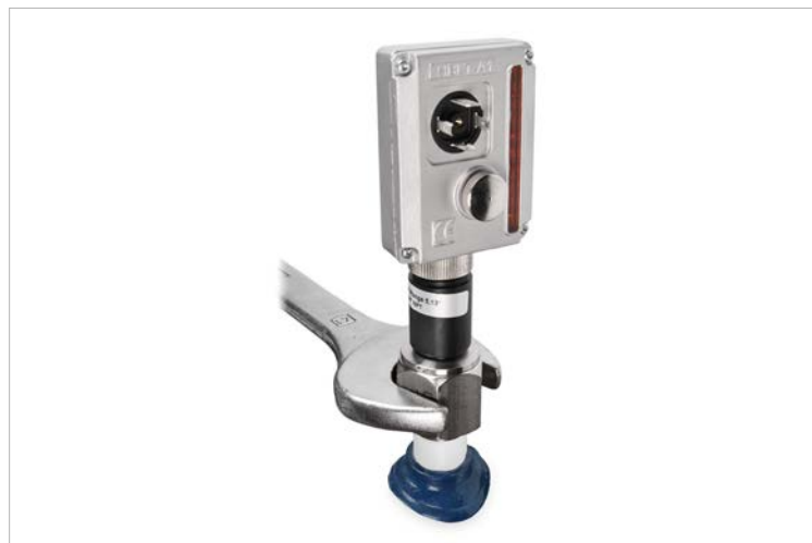
Monter le capteur sur la cuve. Couple 80-150 Nm.
